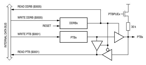
Figure 12-8. Port B I/O Circuit
